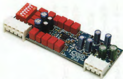
Voyage i20はオプションのフォノボードSequel-mk4(¥35,000/税別)を内部に装着することで、アナログ再生に対応する
